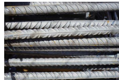
Barres d'acier pour béton armé
